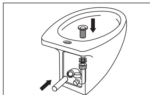
3. Закрепите в технологическом отверстии чаши биде собранный смеситель согласно инструкции по монтажу (поставляется в комплекте со смесителем).
