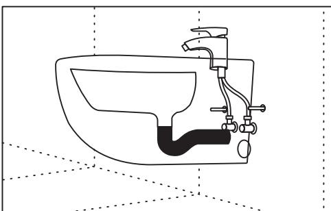
5. Закрепите чашу к инсталляционной раме и подключите изделие к канализации и системе холодного/горячего водоснабжения.
