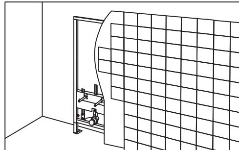
1. Установите, закрепите, отрегулируйте инсталляционную раму согласно инструкции по монтажу (поставляется в комплекте с рамой). Надежно соедините отвод инсталляционной рамы с канализацией и подведите систему водоснабжения.
