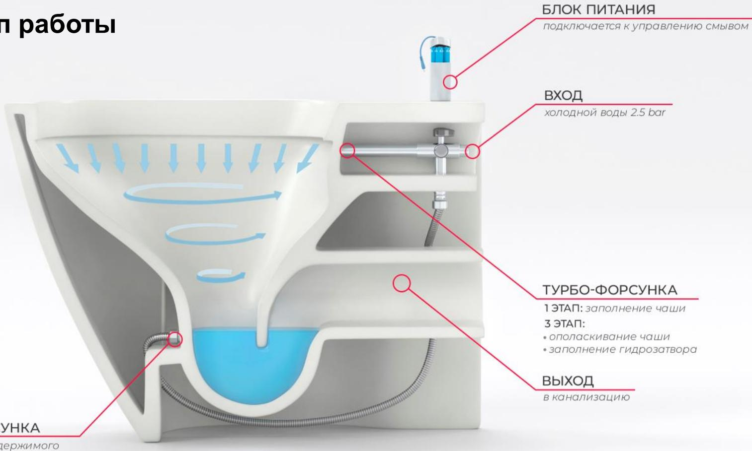
Унитаз подключается напрямую к системе водоснабжения, внутри встроен механизм, работающий на стандартных батарейках.
