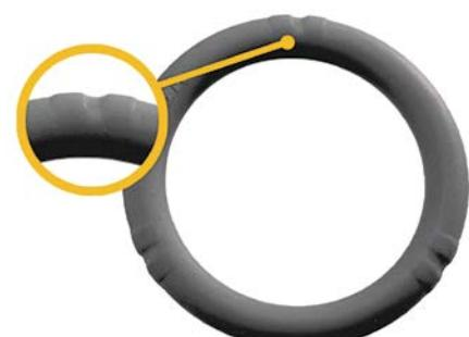
В диапазоне диаметров 15–54 мм, функция LBP реализуется за счет специальной конструкции уплотнительных прокладок типа O-Ring. Благодаря специальным желобкам O-Ring LBP обеспечивает оптимальный контроль соединений во время испытаний давлением.
