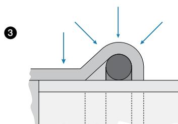
Герметичность соединений в Системе KAN-therm Inox обеспечивает специальное уплотнение O-Ring и трехточечная система обжима типа „M”.
