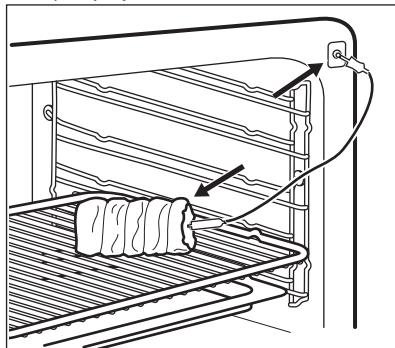
3. С помощью кнопок + или - задайте нужную температуру внутри продукта. Температуру можно задавать в диапазоне от 30°C до 99°C.
