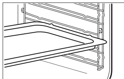
Одновременная установка решетки и глубокого противня:
