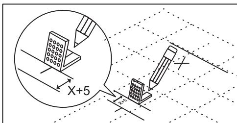
3. Обработайте манжеты и выпуск унитаза технической мазью и поставьте изделие на заранее выбранное для него место на пол. Обведите унитаз по контуру и отметьте положения установочных отверстий. После этого, уберите унитаз и по отмеченному контуру расположите крепежные уголки на расстоянии ( $x+5$  мм) от контура, где  $x$  – толщина керамики.
