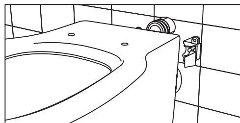
4. Установите унитаз по обведенным контурам, направляя выпуск унитаза в фановую трубу. На выпуск системы подачи воды наденьте соединительную манжету.
