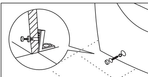
5. Вставьте винты в установочные отверстия и затяните их, после чего, на шляпки винтов наденьте декоративные колпачки.
