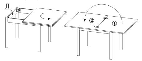
Во избежание произвольного сдвига столешницы, фиксируйте ее в крайних положениях с помощью кнопочных замков (поз.Л).
