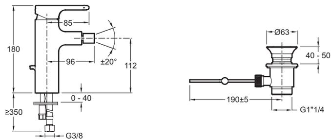
Спецификация продукта: Смеситель для биде и донным клапаном. E10865. Коллекция: SINGULIER. Вес: 2,1 кг. Расход воды: 13 л/мин при давлении 3 бар. Механизм: Последовательный керамический картридж.
