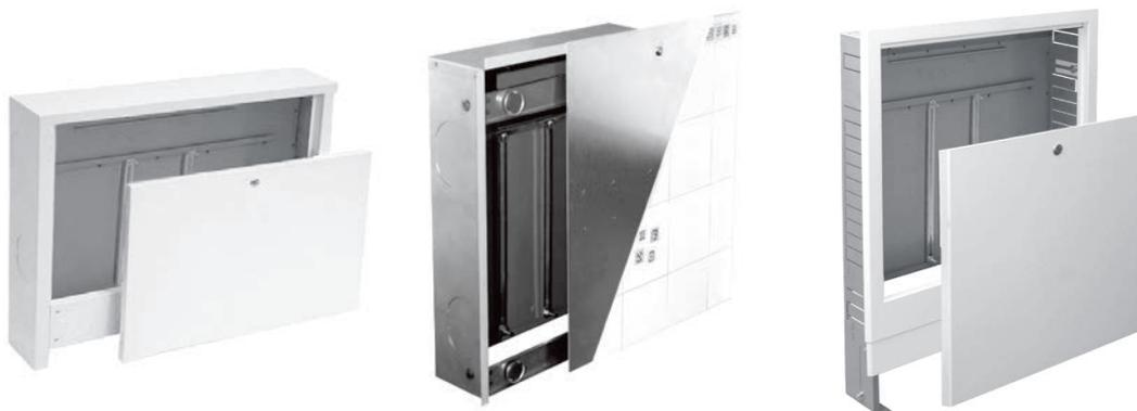
Конструкция шкафчиков для панельного отопления позволяет монтировать распределители со смесительной системой и без смесительной системы. В шкафчиках также предусмотрено место под электрическую клеммную колодку. Клеммные колодки прикручиваются винтами к монтажной шине в верхней части шкафчика (в специально подготовленные отверстия).
