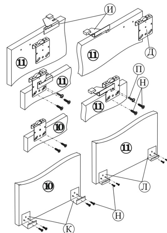
3.8. На боковые двери (дет.№11) установите ходовые ролики (поз.Д) и стопоры (поз.И). Причем стопор ставится на ролик находящийся ближе к боковине шкафа, а амортизатор стопора направлен к центру шкафа. Для крепления стопора к ролику используйте винт (поз.П). На центральную дверь (дет.№10) устанавливаются ролики без стопоров.
