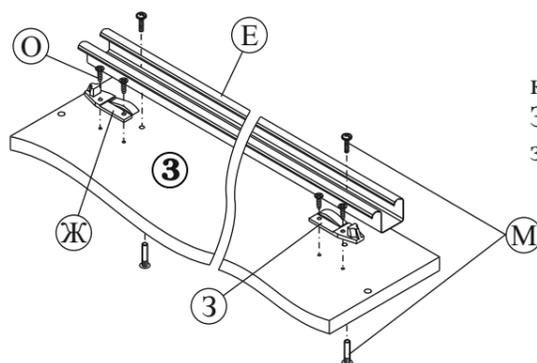
3.1. При помощи шурупов (поз.О) закрепите на крышке, (дет.№3) правый и левый фиксаторы (поз.Ж и З). Затем при помощи межсекционной стяжки (поз.М), закрепите верхний ходовой профиль (поз.Е).
