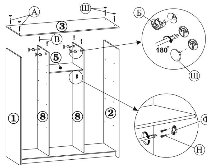
3.6. В крышку (дет.№3) вкрутите четыре штока эксцентрика (поз.В). Затем установите крышку на каркас шкафа, закрепив ее винтовыми стяжками с боками (дет. №1 и №2) и установив эксцентрики (поз.В) в перегородки (дет.№8) поверните их на 180 градусов по часовой стрелке. На деталях №8, под полкой (дет.№5), шурупами закрепите штангодержатели (поз.Ф). Установите штангу (поз.Х).
