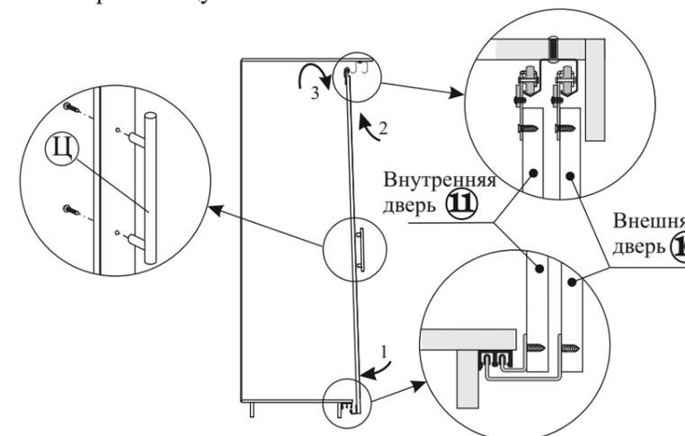
3.10. Установите планку (дет.№9), закрепив ее винтовой стяжкой (поз.А). Установите ручки (поз.Ц).
