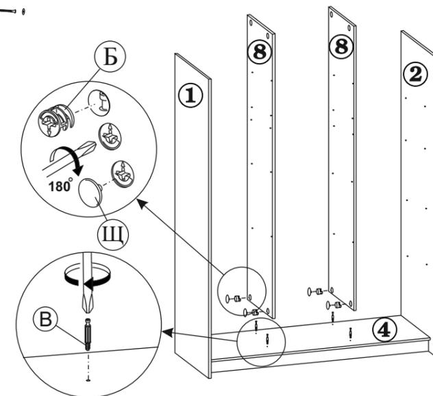
3.5. В детали №8, вкрутите дюбели ввинчиваемые (поз.С). Установите на них полку (дет.№5). Зафиксируйте ее повернув винты вмонтированных в полку эксцентриков по часовой стрелке на 180 градусов. В детали №1, №2 и №8, установите полкодержатели (поз.Т).
